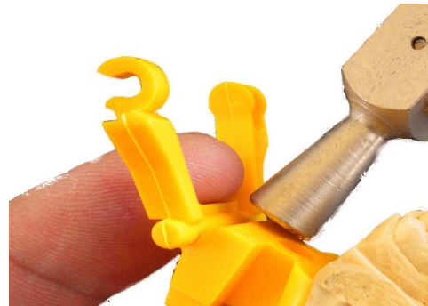
Une fois sortie de la cuvette de coulée, il suffit de quelques petits coups de marteau pour que le modèle se désolidarise de la base
